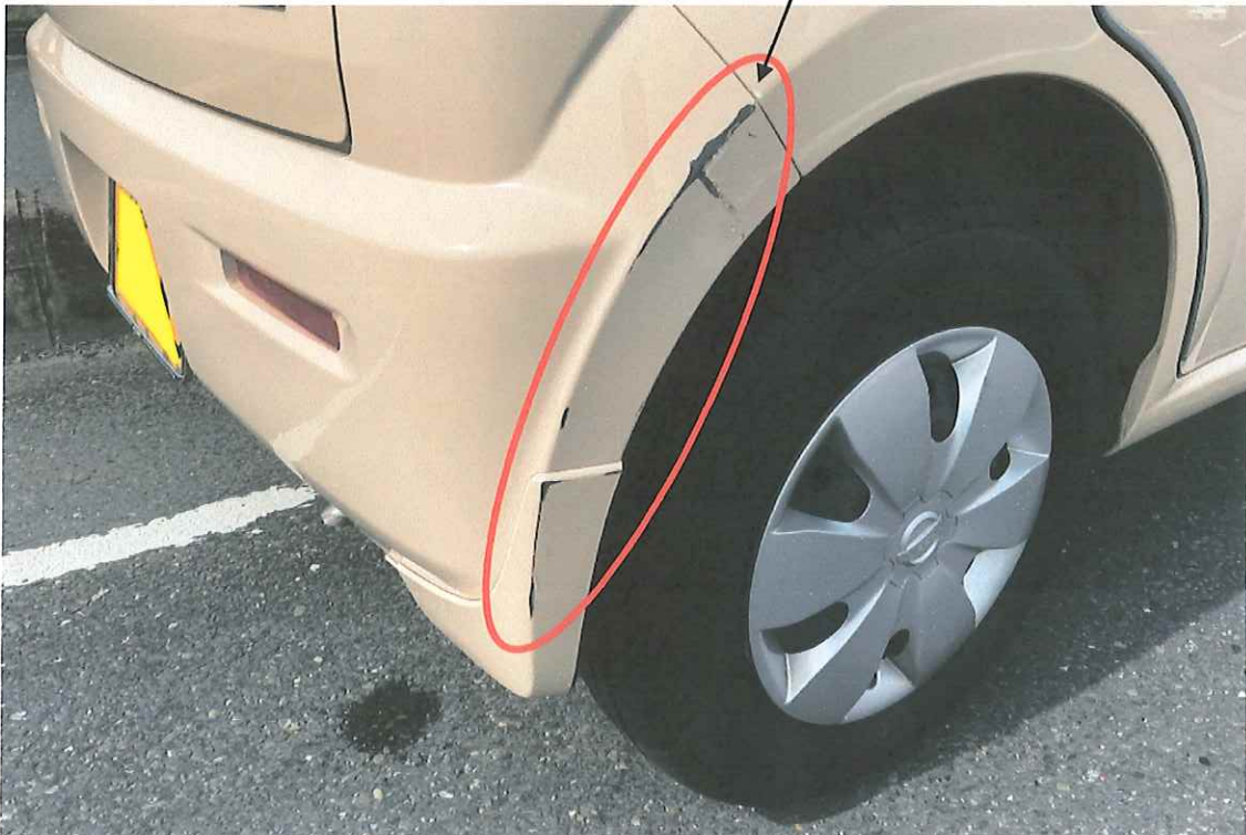
リアフェンダーの凹み及び 擦り傷
